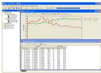
**信号强度扫描:** 测试和报告指定通道的接收信号强度指标 (RSSI) 值，测试带宽可选择，200K 或 3.84MHz;
